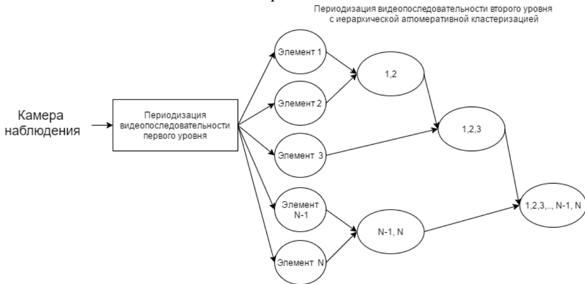
Рис. 1. Схема работы системы видеонаблюдения с автоматической кластеризацией
